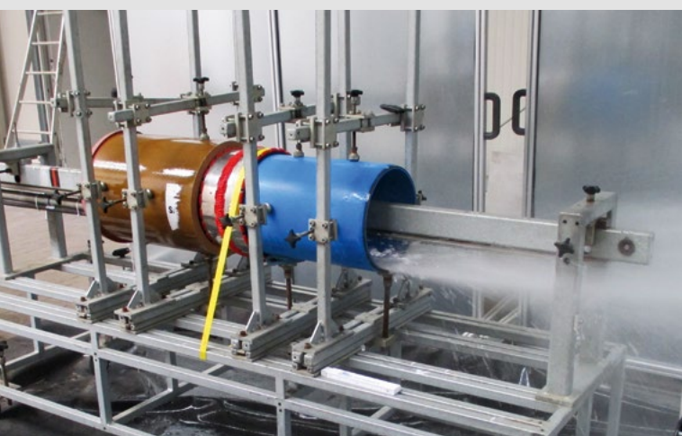
Próba wysokociśnieniowa wg DIN 19523, stanowisko badawcze w IRO Sp z o.o. Oldenburg
